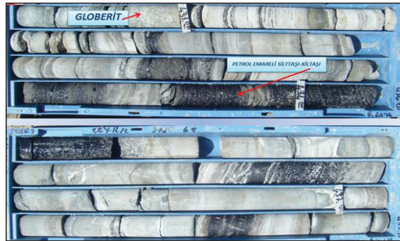
Şekil 1- Konya - Ereğli Yeniköy sondaj karotlarında Globerit-Blödit (Sülfat tuzu) ve Halit ardalanması
