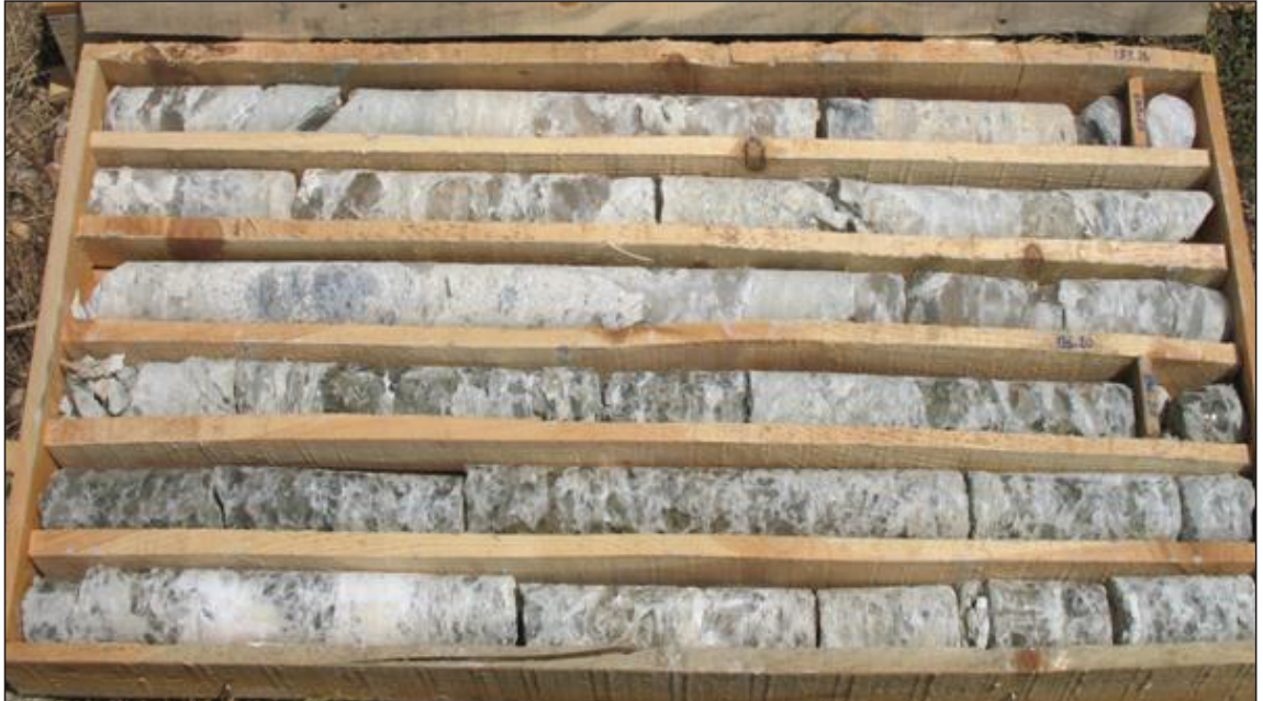
Şekil 3- Eskişehir- Kırka bor cevher karotu (Boraks)
