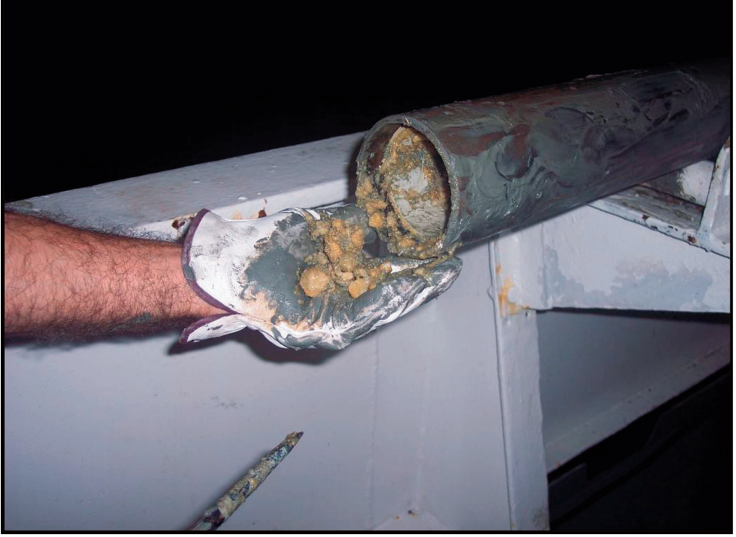
Şekil 9- Gaz hidrat karot örneği. Marmara Denizi Batı Sırtı. Esonet Marmara Denizi Araştırmaları. (Fotograf. Namık Çağatay)
