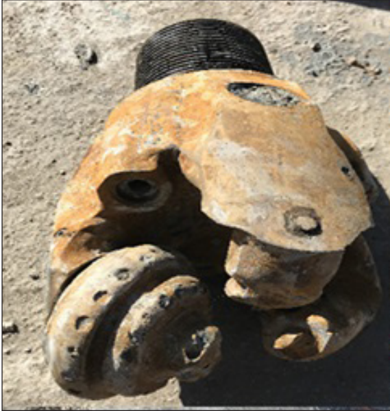
Şekil 1- Çaptan düşmüş ve kuyuda iki konisi kalan 12¼" matkap.
