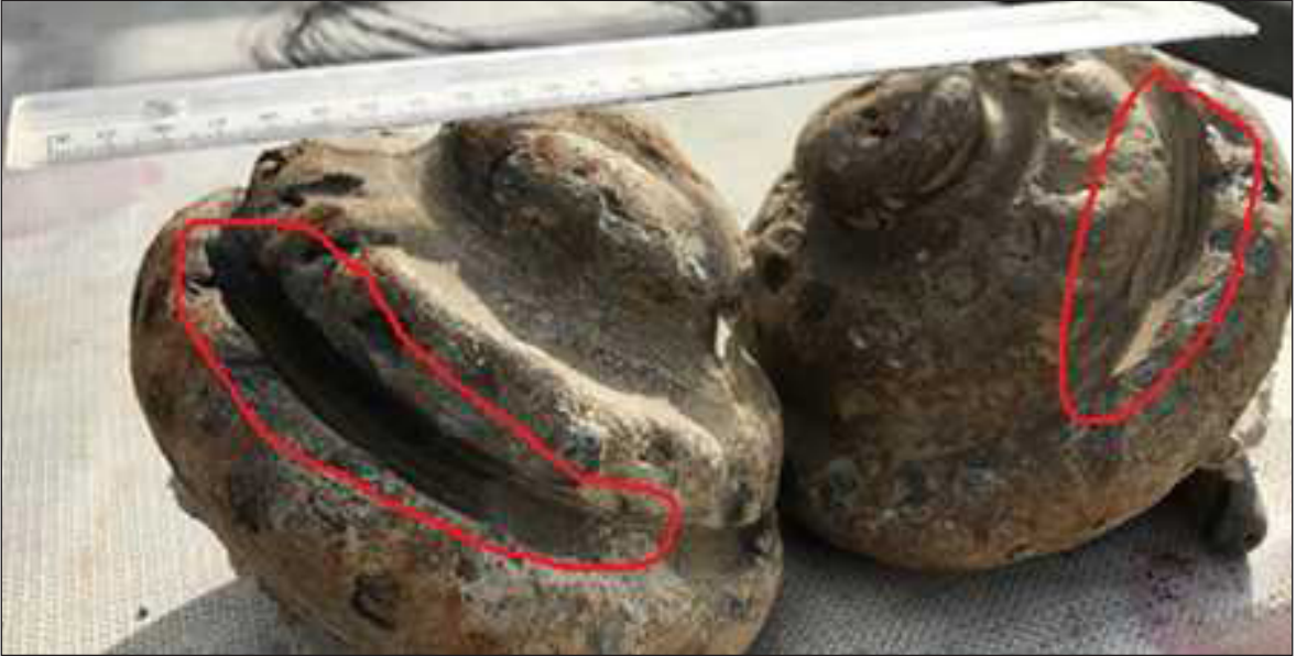
Şekil 6- İki koninin kuyu tabanında duruş şekli.
