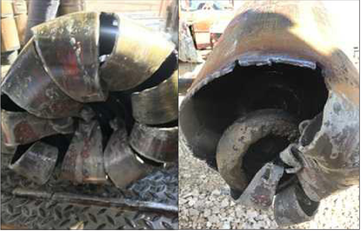
Şekil 5- Kapan tahlisiyenin operasyon sonrası görüntüsü.
