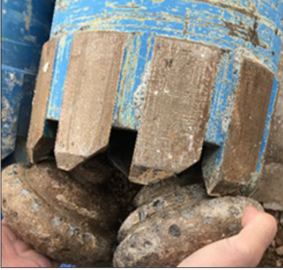
Şekil 7- İki koninin tahliye aparatı ile kuyu tabanında dokunak durumu.
