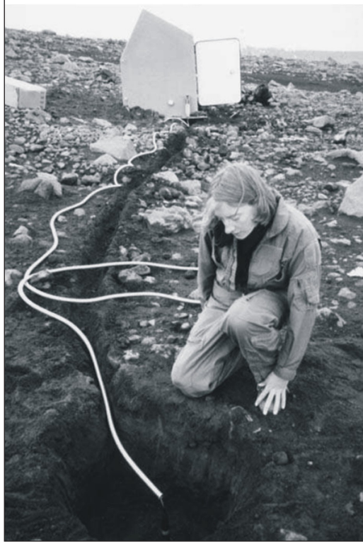
Şekil 5- Alaska, Pavlof volkanına sismometre yerleştirilmesi (McNutt, 2000'den).
