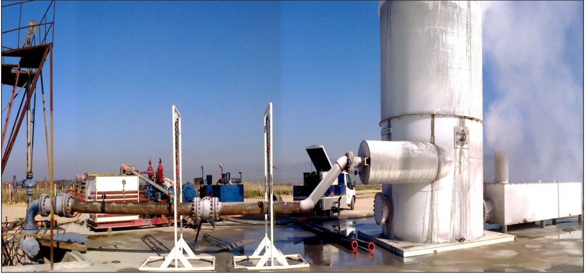
Şekil 8- Silencer-Savak üretim ve test düzeni (Alaşehir).
