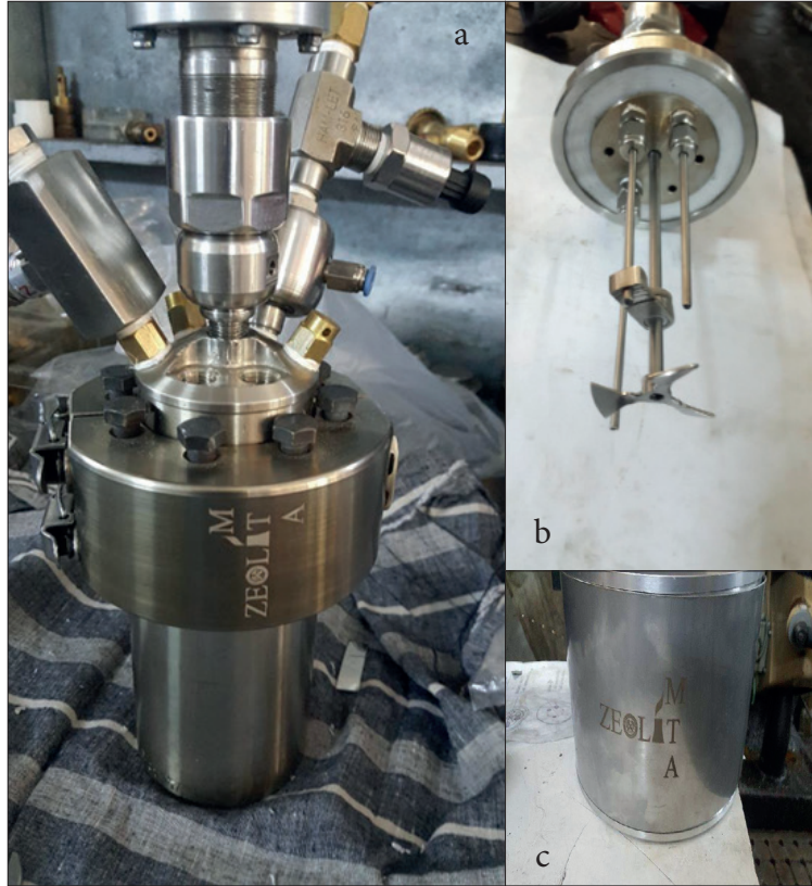
Şekil 3- Tasarımı yapılan yüksek basınçlı reaktör: a) Numune alma hücresi, b) Karıştırıcı ve c) Isı ünitesi sistemlerinin görünümü.
