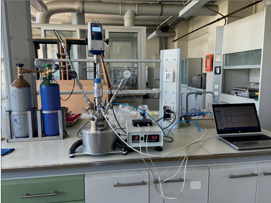
Şekil 4- Yerli üretim ile imal edilmiş yüksek basınçlı ve manyetik karıştırıcılı kimyasal reaktör.
