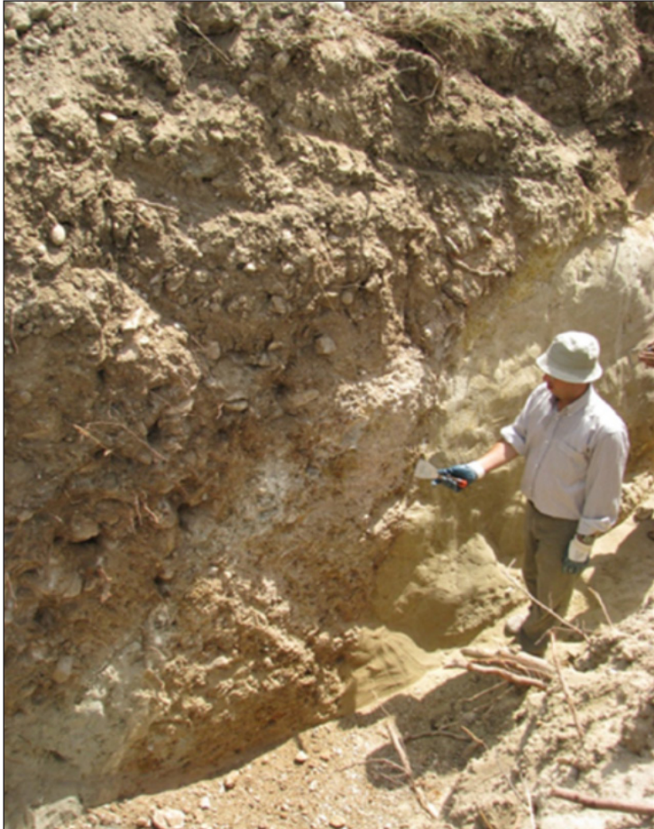
Şekil 10- 1970 Gediz depremi yüzey kırığı üzerinde açılmış hendek duvarı (Gürboğa, 2011)
