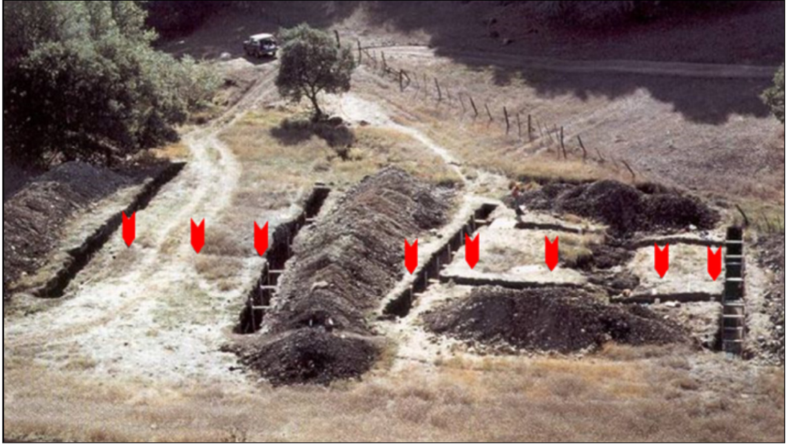
Şekil 9 - Doğrultu atımlı bir fayda açılmış 3 boyutlu hendek çalışması (Pantosti vd., 1996) Kırmızı oklar fayın yüzeydeki izini göstermektedir.
