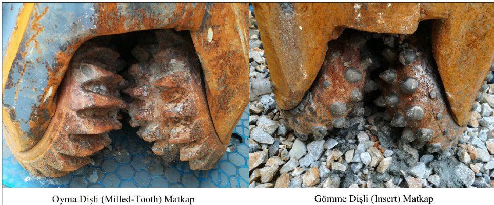
Şekil 5- Döner konlu oyma dişli ve gömme dişli matkaplar.
