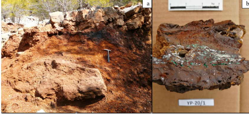
Şekil 9- Yanışlı demir cevherleşmesinde gözlenen cevher mineralleri, a) hematit, limonit ve götit, b) malahit, azurit.
