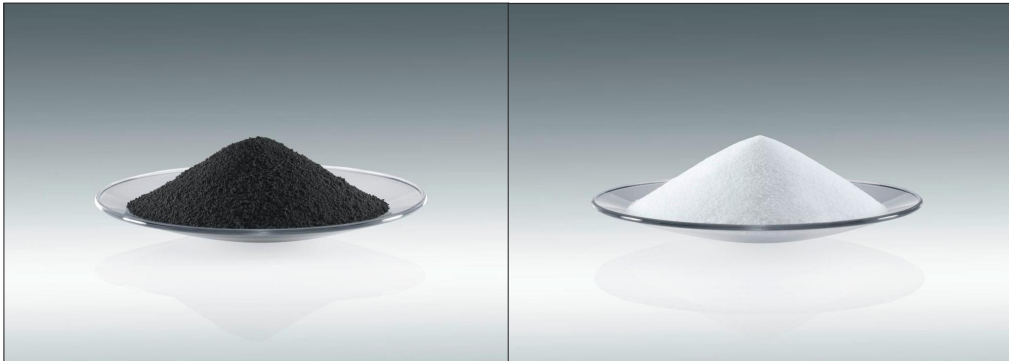
Şekil 3- Tungsten karbür-WC ve amonyum paratungstat-APT tozu (www.hcstarck.com).
