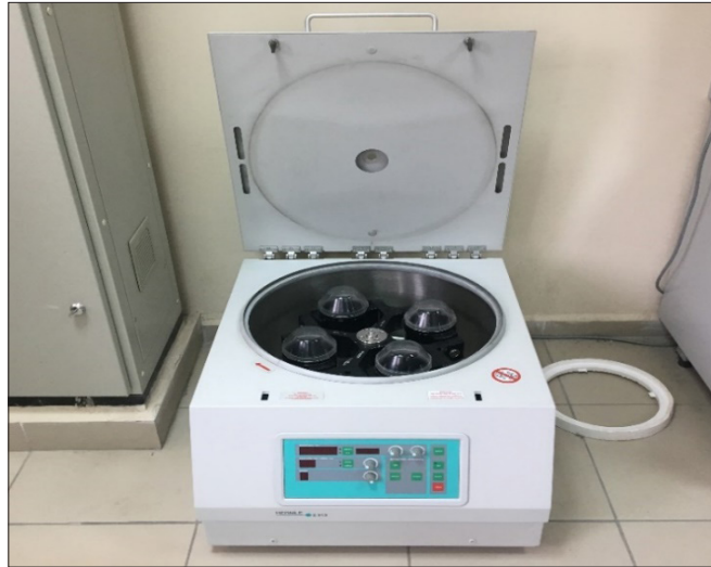
Şekil 3- Şişe çalkalama sonrası katı sıvı ayırımında kullanılan santrifüj (3.600 dev/dk).
