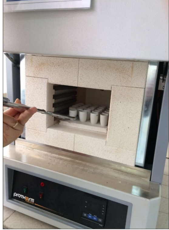
Şekil 9- Sediment örneğinin kül fırınında yakılma süreci.
