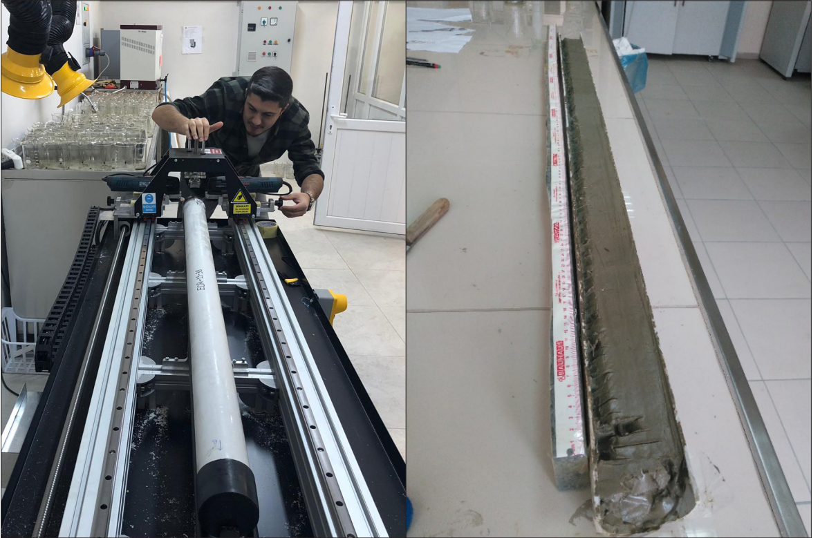
Şekil 3- a) Karot kesme cihazı ile karotun yarılanması, b) Yarılanan karotun arşiv için fotoğraflanması.
