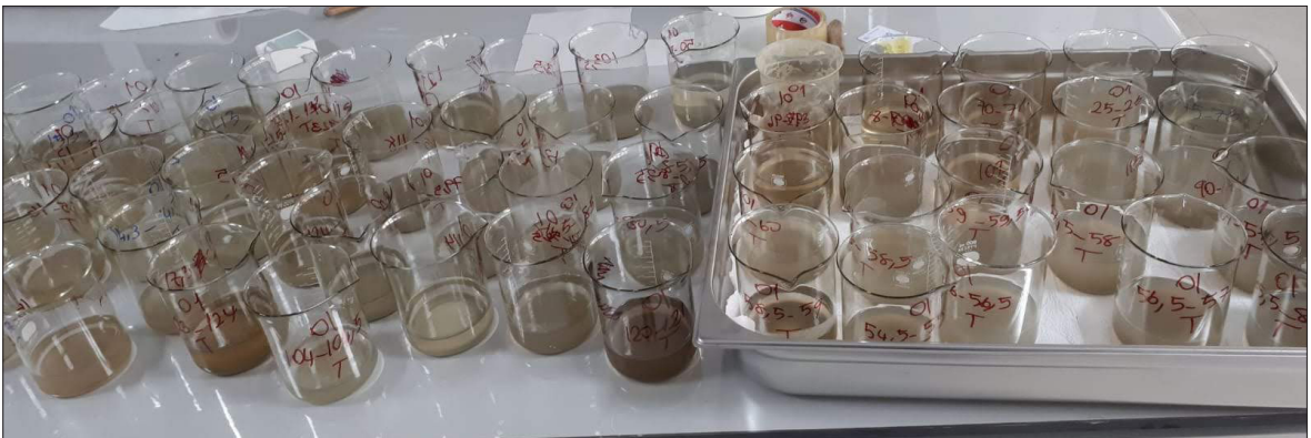
Şekil 6- Tane boyu analizi öncesi hidrojen peroksit ile tepkime süreci.
