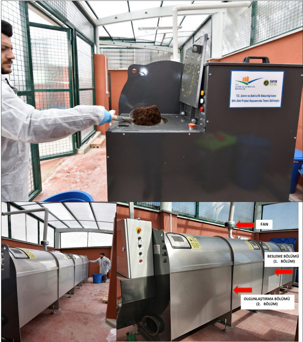
Şekil 9- Kompost makinası ve bölümleri.
