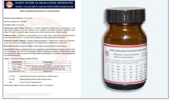
Şekil 5 – MTA tarafından üretilen Dere Sedimanı Referans Numunesi ve sertifikası.
