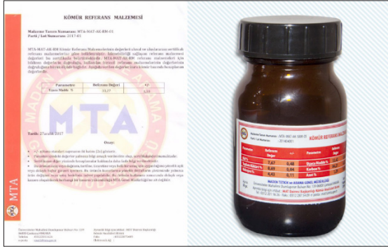
Şekil 3- MTA tarafından üretilen Kömür Referans Numunesi ve sertifikası.
