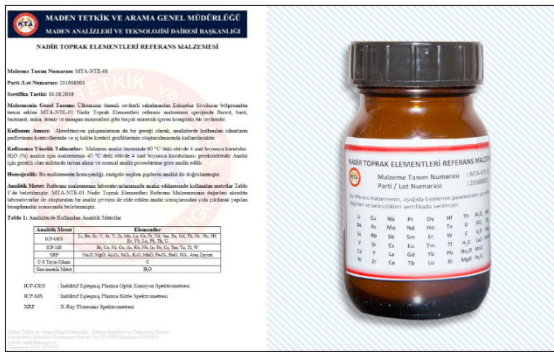
Şekil 4 – MTA tarafından üretilen Nadir Toprak Elementleri Referans Numunesi ve sertifikası.
