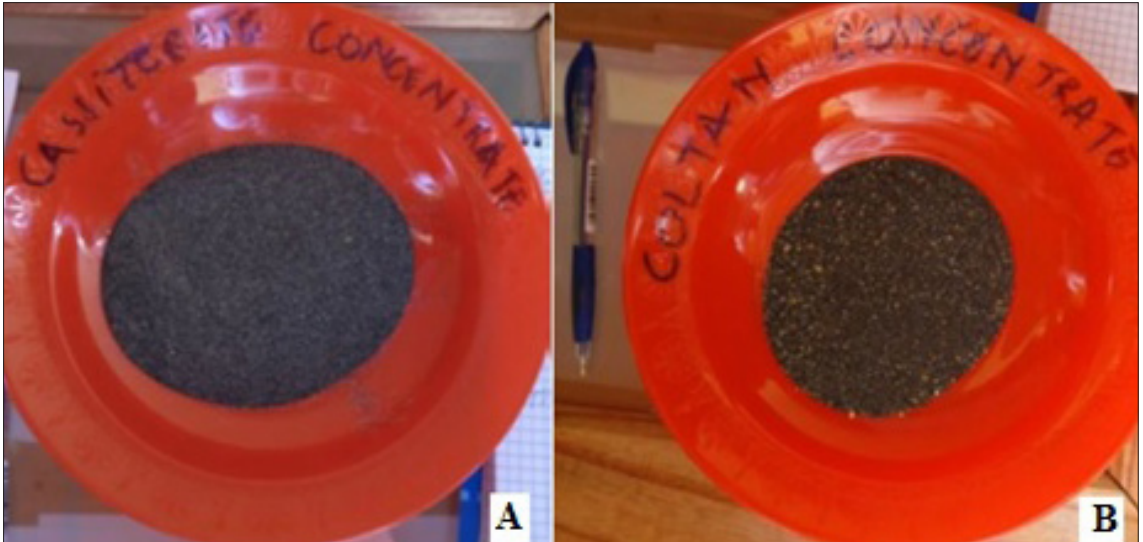
Şekil 2- (a) Kassiterit konsantresi, (b) Koltan (kolumbit-tantalit) konsantresi
