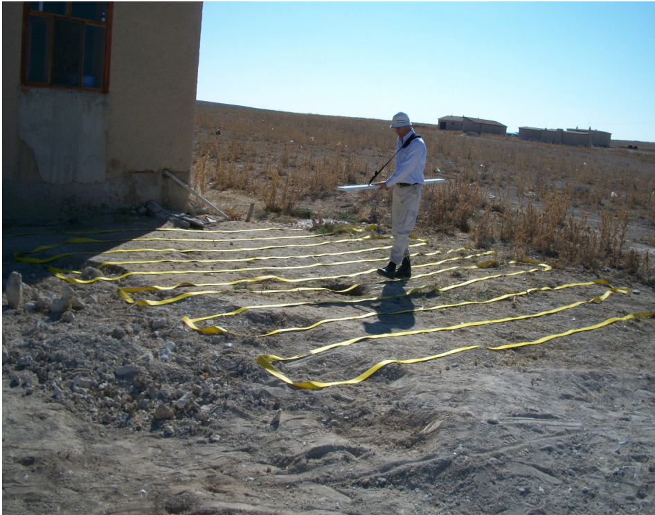
Şekil 2- GEM-2 cihazı ile veri toplama.
