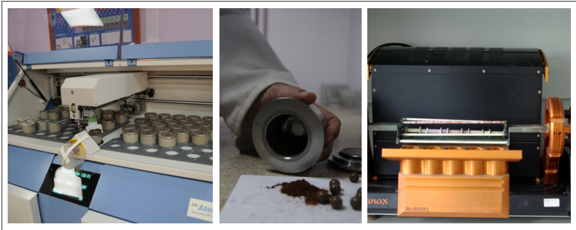
Şekil 5- XRF Cihazı için palet hazırlama
