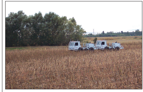
Şekil 4- Arazide vibratörlerin (MiniVib II) çalışmasından görünüm
