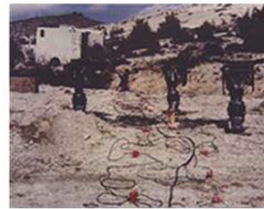
1985 - Beypazarı Trona Arazisi Sismik Çalışmaları DFS V Sismik Kayıt Cihazı (24 kanal) Wacker (Mini-Sosie) Sismik Enerji Kaynağı
