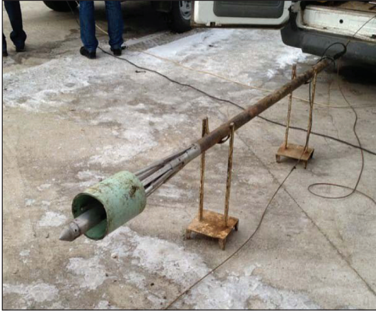
Şekil 3- Caliper Prob Kalibrasyonu
