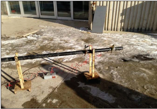
Şekil 4- SP Rezistivite Probu Kalibrasyonu
