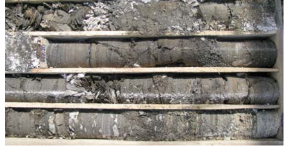
Şekil-1 Konya-Ereğli-Yeniköy sondajında kesilen petrollü şeyl ve sodyum sülfat tuzu-halit araldanması.
