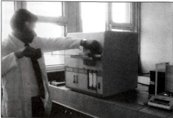
Karbon-Kükürt Analiz Cihazı (LECO SC-144 DR)
